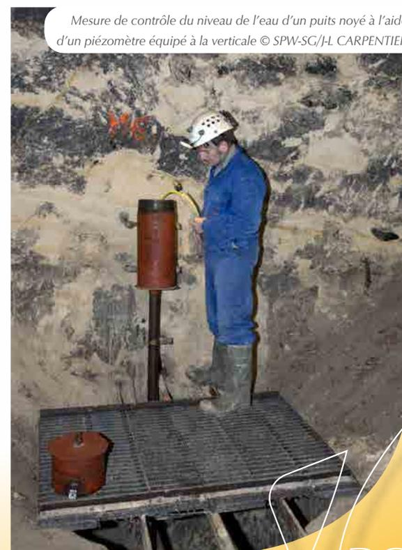
Mesure de contrôle du niveau de l'eau d'un puits noyé à l'aide d'un piézomètre équipé à la verticale © SPW-SC/J-L CARPENTIER
