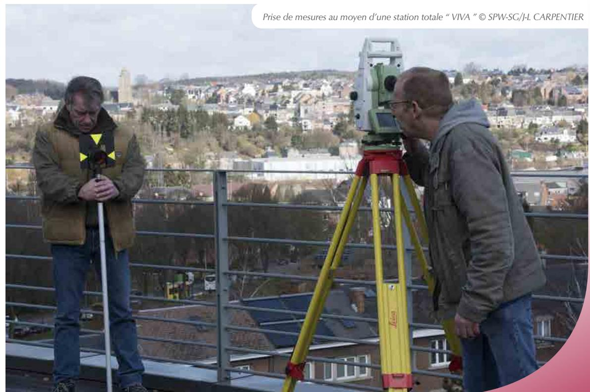
Prise de mesures au moyen d'une station totale "VIVA" © SPW-SG/JL CARPENTIER
