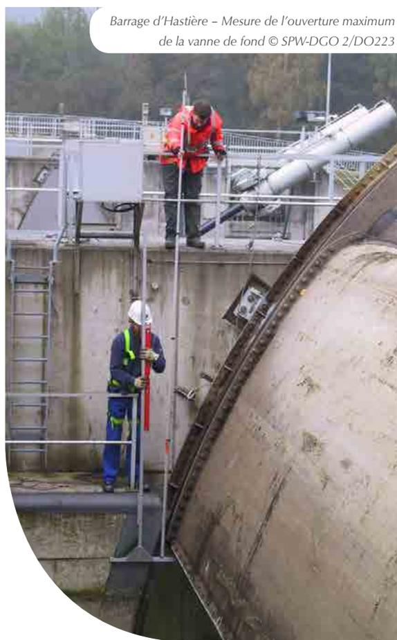
Barrage d'Hastière – Mesure de l'ouverture maximum de la vanne de fond © SPW-DGO 2/DO223
